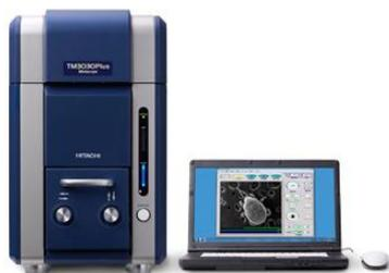
走査型電子顕微鏡 (SEM)は、電子ビームによって対象物を観察する機器です。光学顕微鏡と比較すると焦点深度が深いので、広範囲に焦点の合った立体的な像を得ることができます。SEMを用いることによって電子回路、半導体部品や生体試料など、試料の表面構造を微細に観察が可能になります。
